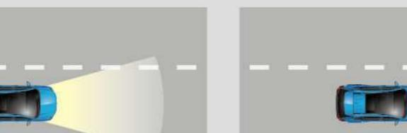
偵測對向車輛頭燈及前方車輛尾燈光源，自動切換遠光燈，避免來車受到頭燈直射。
