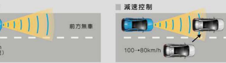
啟動ACC全速域主動式車距維持定速系統後，系統將以毫米波雷達及智能攝影機偵測前方車輛速度，並自動加速、減速或停止，駕駛無須長時間踩踏油門，增加巡航的便利性及安全性。
