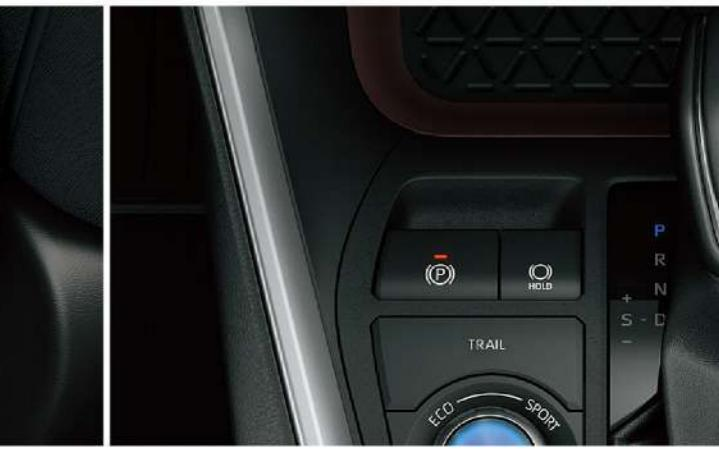
■ EPB電子駐車煞車系統 (附Auto Hold功能)
