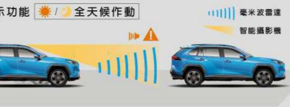
透過毫米波雷達與智能攝影機協同偵測前方車輛、及障礙物與行人，能依據前方路況，即時於多功能資訊幕顯示警示訊息，並發出警示音，提醒駕駛採取反應。
