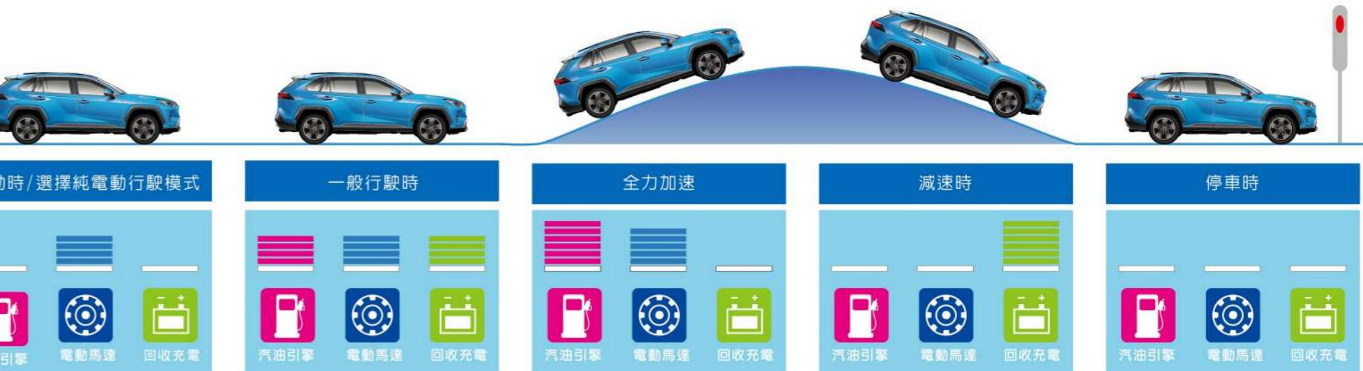
當按下EV Mode按鈕，或車輛由靜止啟動時，車輛可以僅靠電動馬達有效地被交互運用，以達到最省油的動力輸出狀態。當引擎輸出動力超過實際駕駛需求時，多餘動力將為HYBRID電池充電，提供最有效率的動能運用。
