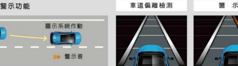
後視鏡前方智能攝影機可偵測路面分隔線，於時速50公里以上而未打方向燈、且系統判斷偏離車道時，多機能資訊顯示幕會顯示警示訊息，並響起警示音以提醒駕駛。
