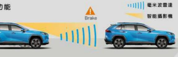
當判定極有可能與前方車輛、障礙物、行人發生碰撞風險，必要時系統將自動啟動煞車，避免事故發生或降低意外造成的傷害。
