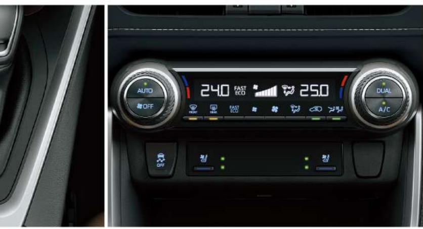
■ S-Flow智慧型雙區恆溫控制空調系統
