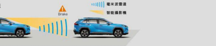
行車輛、障礙物、行人發生碰撞風險，必要時系統將自動發生或降低意外造成的傷害。
