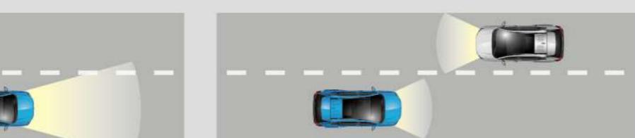
前方車輛尾燈光源，自動切換遠光燈，避免來車受到頭燈直射。
