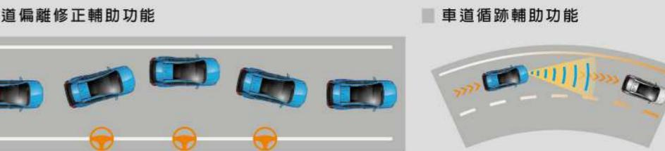
當判斷車輛可能偏離車道時，系統會於方向盤施予反向回饋，修正行車路線，協助車輛維持行駛在車道內。
