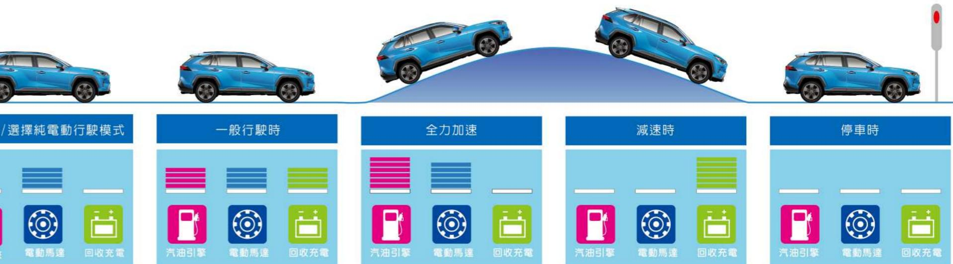
當按下EV Mode按鈕，或車輛由靜止啓動時，車輛可以僅靠電動馬達有效地被交互運用，以達到最省油的動力輸出狀態。當引擎輸出動力超過實際駕駛需求時，多餘動力將為HYBRID電池充電，提供最有效率的動能運用。
