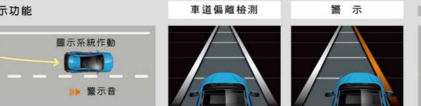
攝影機可偵測路面分隔線，於時速50公里以上而未打方向燈、且系統判斷偏離車道時，儀會顯示警示訊息，並響起警示音以提醒駕駛。
