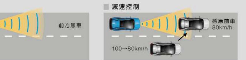
主動式車距維持定速系統後，系統將以毫米波雷達及智能攝影機偵測前方車速或停止，駕駛無須長時間踩踏油門，增加巡航的便利性及安全性。
