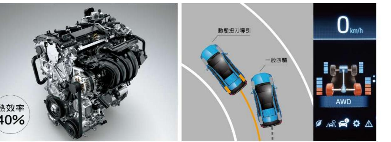
透過獨立設置在左右後輪軸的傳動連結器，可以獨立控制左右後輪的扭力，達到四輪最佳的扭力配置，大幅提升車輛過彎的循跡性及轉向性。
