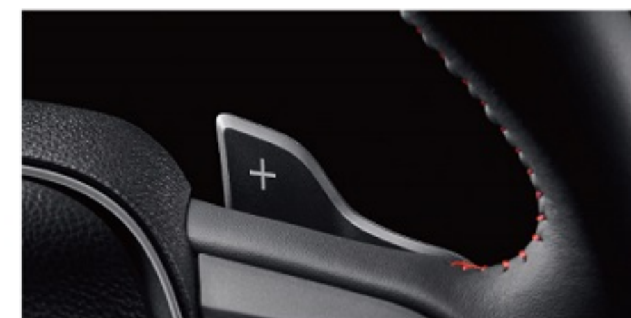
方向盤換檔撥片附7速手自排功能 (GR SPORT 汽油)
