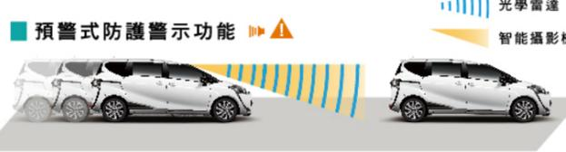
透過光學雷達與智能攝影機協同偵測前方車輛，能依據前方路況，即時於多功能資訊幕顯示警示訊息，並發出警示音，提醒駕駛採取反應。
