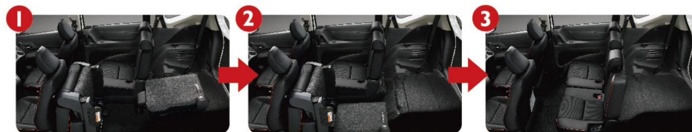
1. 透過拉桿輕鬆將第二排座椅翻滾收折，並將第三排座椅傾倒。
