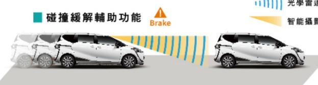
當判定極有可能與前方車輛發生碰撞風險，必要時系統將自動啟動煞車，避免事故發生或降低意外造成的傷害。
