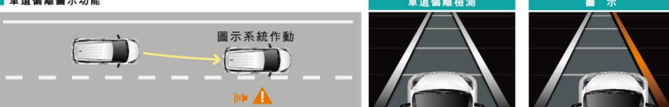
後視鏡前方智能攝影機可偵測路面分隔線，於時速 50 公里以上而未打方向燈、且系統判斷偏離車道時，多功能資訊顯示幕會顯示警示訊息，並響起警示音以提醒駕駛。
