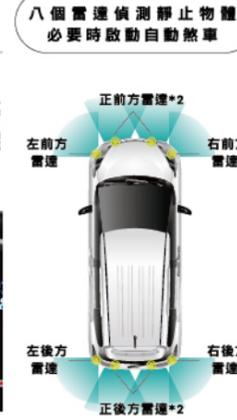
八個雷達偵測靜止物體 必要時啟動自動煞車
