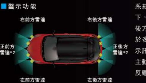
系統於時速15km/h以下，透過雷達偵測前、後方靜止障礙物，即時於多功能資訊幕顯示警訊並發出警示音，主動提醒駕駛採取必要反應。
