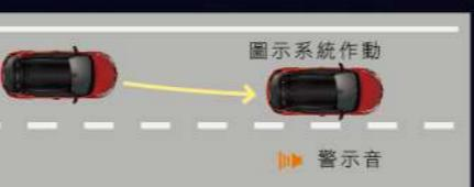
後視鏡前方智能攝影機可偵測路面分隔線，於時速50公里以上而未打方向燈、且系統判斷偏離車道時，多機能資訊顯示幕會顯示警示訊息，並響起警示音以提醒駕駛。
