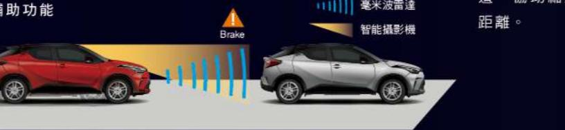
當判定極有可能與前方車輛、行人及自行車手發生碰撞風險，必要時系統將自動啟動煞車，避免事故發生或降低意外造成的傷害。
