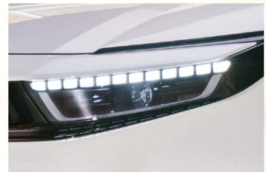
LED Bi-Beam 前車燈（附自動水平調整）
