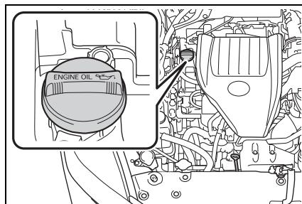
1 逆時針方向轉動機油加油蓋並拆下。
