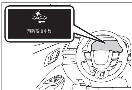
如果系統判定加速踏板被用力踩下，MID 多功能資訊顯示幕會顯示以下圖示和訊息。
