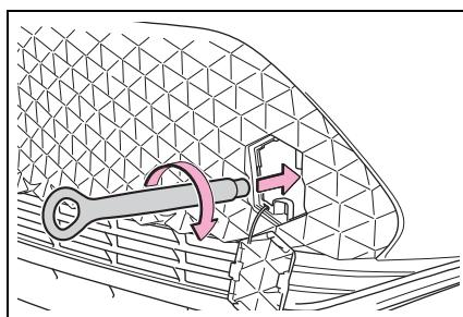
**4 使用輪圈螺栓扳手或堅硬的金屬棒將拖吊鉤環鎖緊。**
