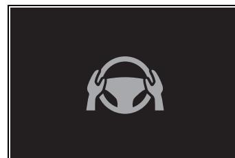
● 當系統判定駕駛者未牢牢握住方向盤時，或者當車道偏離預防功能的轉向輔助操作作動，但未操作方向盤時
