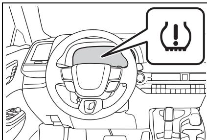
**9 若安裝輪組的規定胎壓與前一組相異，便需執行 TPMS 胎壓偵測警示系統的胎壓設定程序。
