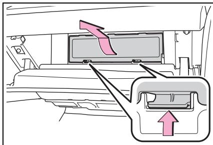
5 解除濾芯外蓋鎖定 (**B**)、拉出固定爪 (**A**)，然後拆下濾芯飾蓋。
