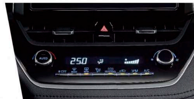
|| S-FLOW 智慧型恆溫空調系統 (HYBRID車型、汽油尊爵、汽油豪華) 當後座無乘客時，啟動S-FLOW，後座出風口即不出風，同時系統能自動依據車內外溫度、前乘客座有無乘客等參數以決定前乘客座側是否出風，兼具舒適、節能的冷暖房效果。
