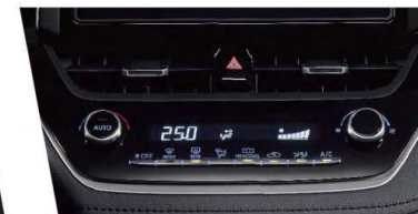
S-FLOW 智慧型恆溫空調系統(HYBRID車型、汽油尊爵、汽油豪華) 當後座無乘客時，後座S-FLOW後座出風口即不出風，同時系統能自動從車內外溫度、 前乘客座有無乘客等參數以決定前乘客吹風是否出風，兼具舒適、節能的冷暖房效果。
