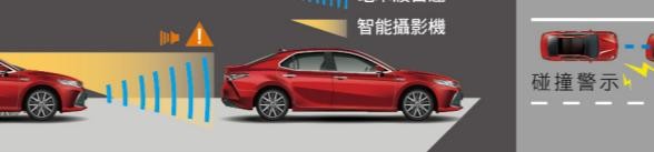
透過毫米波雷達與智能攝影機協同偵測前方車輛、障礙物與行人，能依據前方路況，即時於多功能資訊幕顯示警示訊息，並發出警示音，提醒駕駛採取反應。
