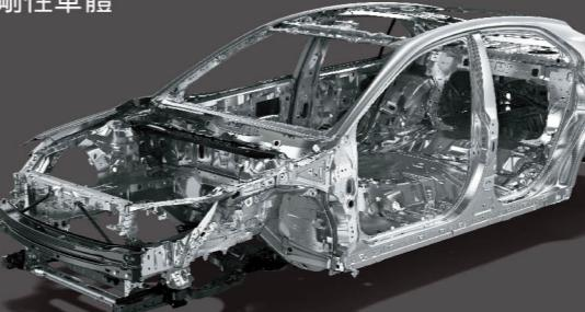
車身結構最高採用1,500 MPa等級超高強度鋼材，搭配能有效吸收並分散前方撞擊能量的潰縮式前懸設計，可降低車室變形程度，保護乘客安全。
