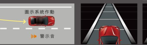
後視鏡前方智能攝影機可偵測路面分隔線，於時速50公里以上而未打方向燈、且系統判斷偏離車道時，多功能資訊顯示幕會顯示警示訊息，並響起警示音以提醒駕駛。
