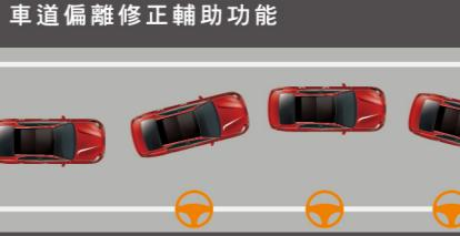
當系統判斷車輛可能偏離車道時，系統會於方向盤施予反向回饋力道，修正行車路線，協助車輛維持行駛在車道內。
