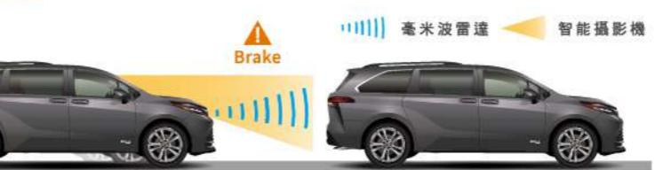
當判定極有可能與前方車輛、障礙物、行人發生碰撞風險，必要時系統將自動啟動煞車，避免事故發生或降低意外造成的傷害。
