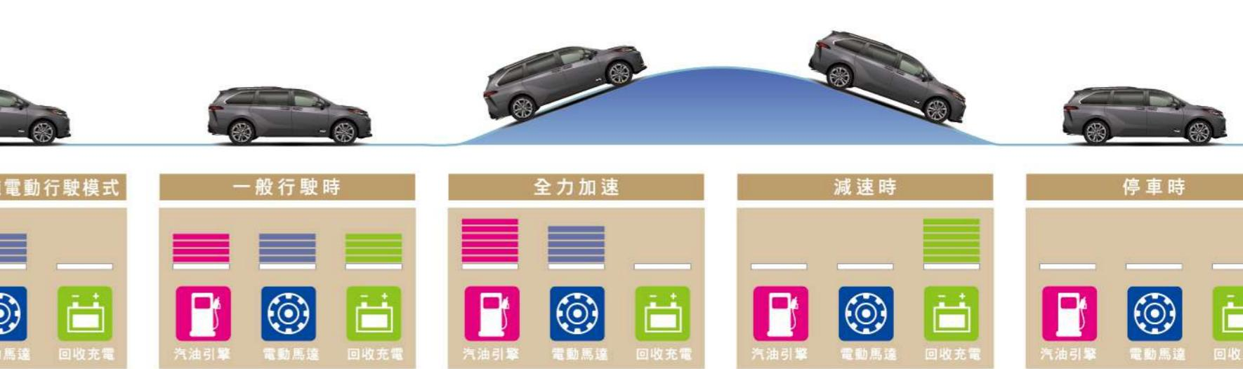
當按下EV Mode按鈕，或車輛由靜止啟動時，車輛可以僅靠電動馬達會有效地被交互運用，以達到最省油的動力輸出狀態。當引擎輸出動力超過實際駕駛需求時，多餘動力將為HYBRID電池充電，提供最有效的動能運用。
