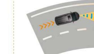
搭配ACC全速域主動式車距維持定速系統作動時，車道循跡輔助功能可將車輛行駛路線維持於車道中心，在容易疲憊的長程旅途中降低意外發生的可能性。
