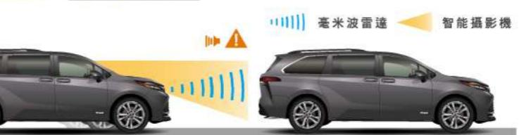
透過毫米波雷達與智能攝影機協同偵測前方車輛、障礙物與行人，能依據前方路況，即時於多功能資訊幕顯示警示訊息，並發出警示音，提醒駕駛採取反應。
