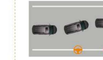
當系統判斷車輛可能偏離車道時，系統會於方向盤施予反向回饋力道，修正行車路線，協助車輛維持行駛在車道內。
