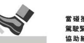
當碰撞風險增加時，系統將加大駕駛緊急煞車時的煞車輔助力道，協助縮短煞停的距離。
