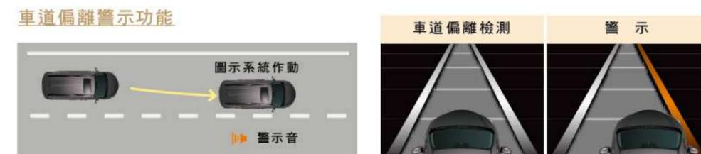
後視鏡前方智能攝影機可偵測路面分隔線，於時速50公里以上而未打方向燈、且系統判斷偏離車道時，多功能資訊顯示幕會顯示警示訊息，並響起警示音以提醒駕駛。
