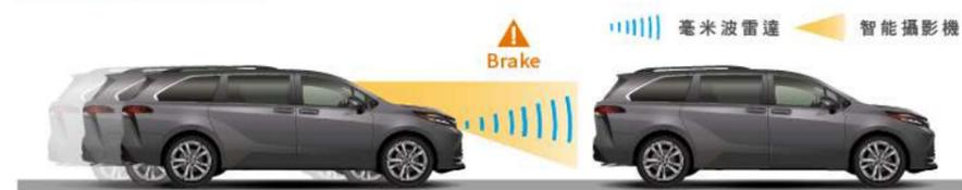
當判定極有可能與前方車輛、障礙物、行人發生碰撞風險，必要時系統將自動啟動煞車，避免事故發生或降低意外造成的傷害。
