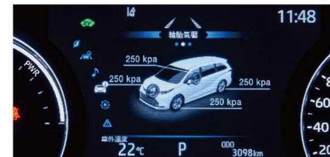
以電腦精密監測輪胎壓力，當任一輪胎胎壓不足時，儀錶板將顯示胎壓警示，讓行車更加安全有保障。
