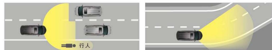
AHS智慧型遠光燈自動遮蔽系統可偵測對向車輛頭燈或前方車輛尾燈光源，將會影響對向或前方車輛駕駛者視線的遠光燈照射範圍進行遮蔽，避免因頭燈直射眩光產生危險，並能提供陰暗處及行人充分之照明；且於車輛轉彎時，改變照明亮度，提升彎道照明以提供良好視野，全方位提升行車安全。
