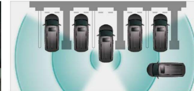
倒車時，透過雷達偵測後方車側障礙物，即時於多功能資訊幕及影音主機畫面顯示警示訊息並發出警示音，當系統判斷極有可能與後方車側障礙物發生碰撞，將主動降低引擎出力，並主動煞車，降低碰撞風險。
