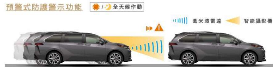
透過毫米波雷達與智能攝影機協同偵測前方車輛、障礙物與行人，能依據前方路況，即時於多功能資訊幕顯示警示訊息，並發出警示音，提醒駕駛採取反應。
