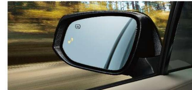
行駛於市區或高速道路上，系統能隨時自動偵測後方盲點區域的來車，以警示燈提醒駕駛，大幅提升變換車道時的行車安全。
