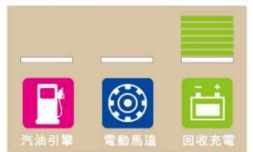
當鬆開油門或踩下煞車踏板時，電動馬達會將減速動能轉換為電能，儲存於HYBRID電池中。
