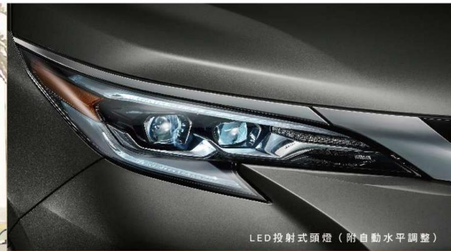
LED投射式頭燈（附自動水平調整）
