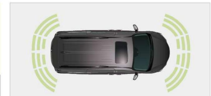
配備八支雷達，當車輛接近障礙時能夠透過聲音與圖像顯示於儀錶板，即時警示駕駛者避免車輛碰撞。
