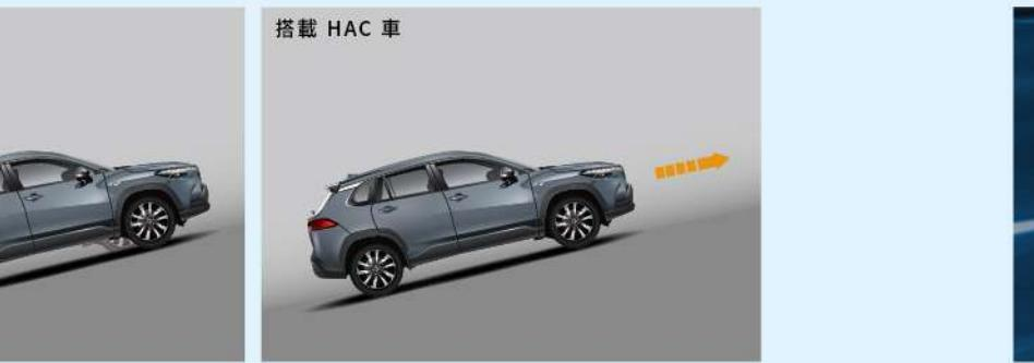
當車輛行駛於上坡道起步時，系統將驅動煞車輔助駕駛進行操控，減低車輛於上坡發生下滑的情形。
