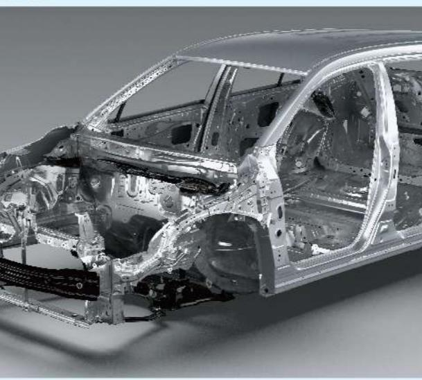
藉由一體式側面加強板、焊點數量增加、底盤剛性強化支架等剛性強化工藝，提升車身抗扭曲剛性；同時藉由重新設計之車身結構，及最高採用 1,620MPa 超高張力鋼材等，能有效吸收分散撞擊能量，保持座艙空間完整性，確保行車安全。
