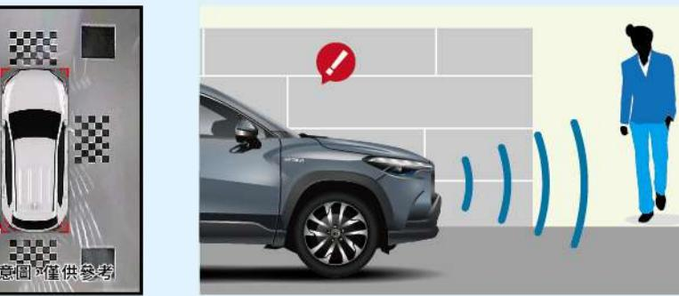
當車速低於時速25公里或倒車時，系統會自動發出聲響提醒行人，以避免巷弄間油電車以電力行駛時，發生行人未察覺、遭受碰撞的意外。
