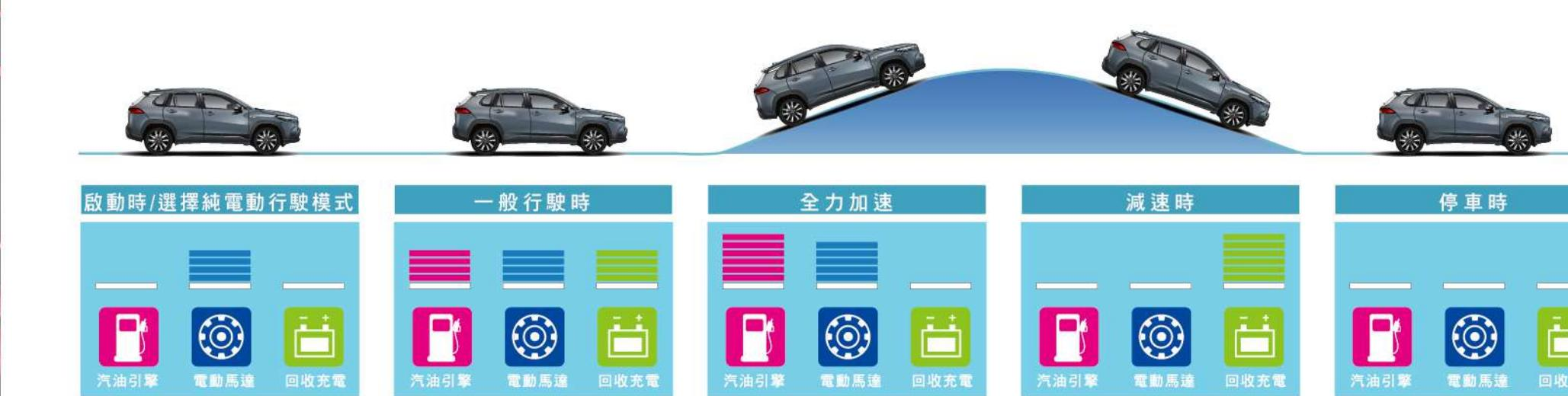
當按下EV Mode按鈕，或車輛由靜止啟動時，車輛可以僅靠電動馬達有效率地被交互通用，以達到最省油的動力輸出狀態。當引擎輸出動力超過實際駕駛需求時，多餘動力將為HYBRID電池充電，提供最有效的動能運用。
