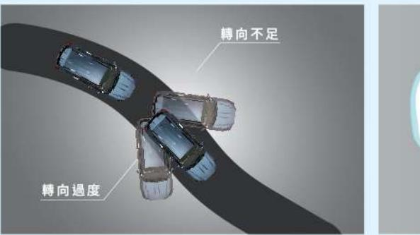
當車輛偏離路面、轉向過度或不足時，VSC 將調整動力輸出，再透過EPS電子式動力輔助方向盤修正方向盤角度，主動掌握行車安全。
