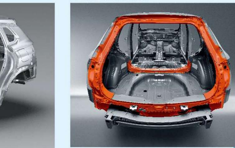
在車尾門及後座的車體結構均採用環狀骨骼設計，大幅提升車輛結構強度，當遭遇外部衝擊時，能提供車室最佳的安全守護。
