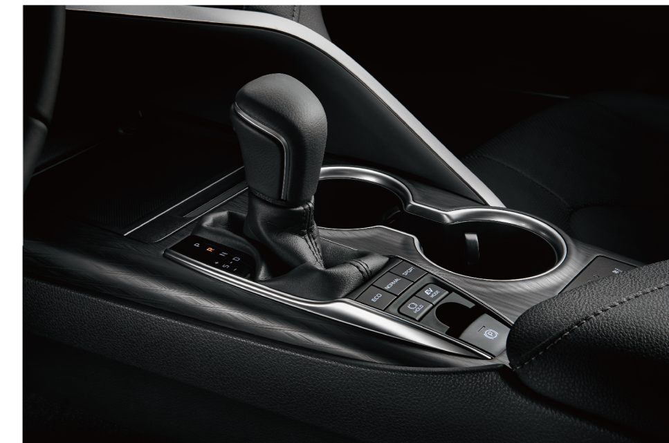
Auto Hold自動定車煞車系統 / EPB電子駐車煞車系統 多重駕駛模式功能 (ECO / SPORT / NORMAL) (HYBRID車型)
