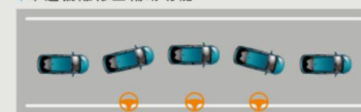
當系統判斷車輛可能偏離車道時，系統會於方向盤施予反向回饋力道，修正行車路線，協助車輛維持行駛在車道內。
