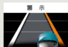
後視鏡前方智能攝影機可偵測路面分隔線，於時速50公里以上而未打方向燈、且系統判斷偏離車道時，多功能資訊顯示幕會顯示警示訊息，並響起警示音以提醒駕駛。
