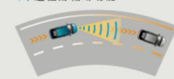
搭配ACC全速域主動式車距維持定速系統作動時，車道循跡輔助功能可將車輛行駛路線維持於車道中心，在容易疲憊的長程旅途中降低意外發生的可能性。
