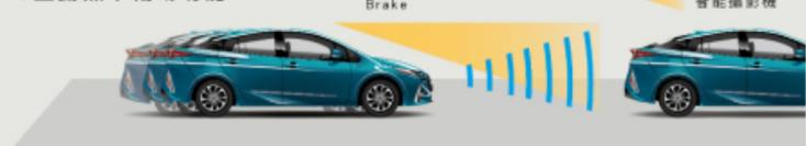
當判定極有可能與前方車輛、行人及自行車手發生碰撞風險，必要時系統將自動啟動煞車，避免事故發生或降低意外造成的傷害。
