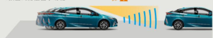
透過毫米波雷達與智能攝影機協同偵測前方車輛、行人及自行車手，能依據前方路況，即時於多功能資訊幕顯示警示訊息，並發出警示音，提醒駕駛採取反應。
