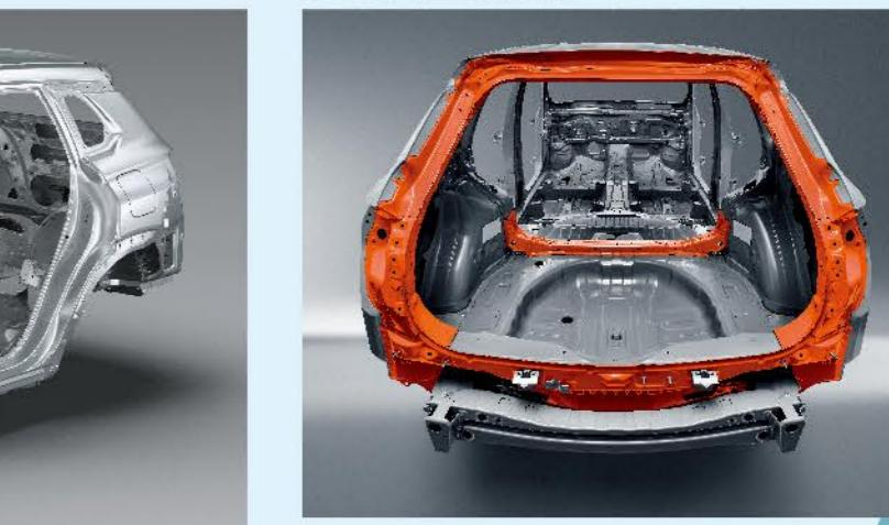
在車尾門及後座的車體結構均採用環狀骨骼設計，大幅提升車輛結構強度，當遭遇外部衝擊時，能提供車室最佳的安全守護。
