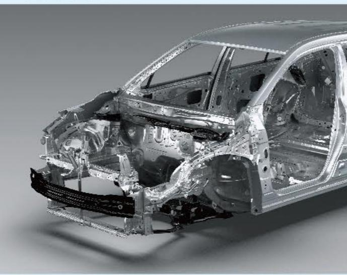
藉由一體式側面加強板、焊點數量增加、底盤剛性強化支架等剛性強化工藝，提升車身抗扭曲剛性；同時藉由重新設計之車身結構，及最高採用 1,620MPa 超高張力鋼材等，能有效吸收分散撞擊能量，保持座艙空間完整性，確保行車安全。
