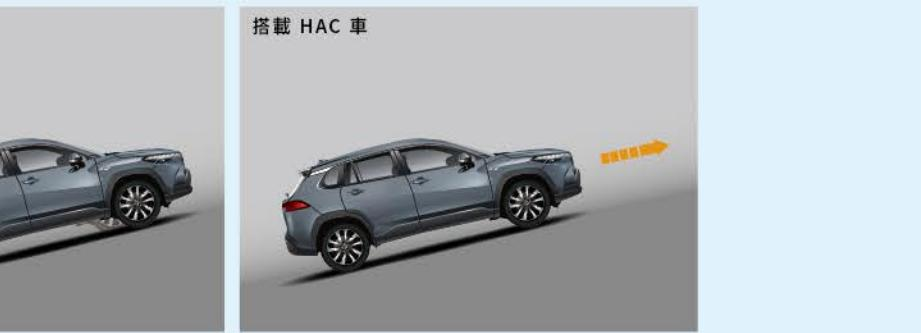
當車輛行駛於上坡道起步時，系統將驅動煞車輔助駕駛進行操控，減低車輛於上坡發生下滑的情形。
