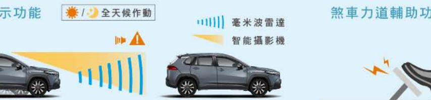
透過毫米波雷達與智能攝影機協同偵測前方車輛、行人及自行車手，能依據前方路況，即時於多功能資訊幕顯示警示訊息，並發出警示音，提醒駕駛採取反應。
