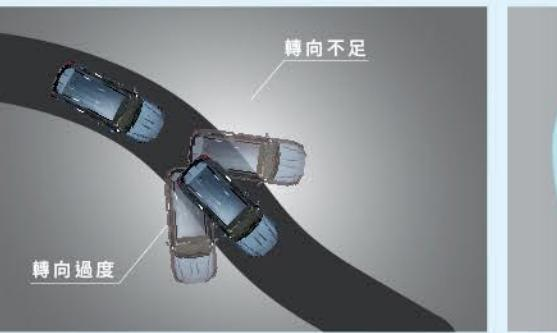
當車輛偏離路面、轉向過度或不足時，VSC 將調整動力輸出，再透過EPS電子式動力輔助方向盤修正方向盤角度，主動掌握行車安全。
