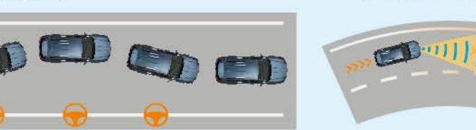
當系統判斷車輛可能偏離車道時，系統會於方向盤施予反向回饋力道，修正行車路線，協助車輛維持行駛在車道內。
