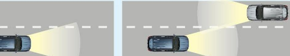
偵測對向車輛頭燈及前方車輛尾燈光源，自動切換遠光燈，避免來車受到頭燈直射。
