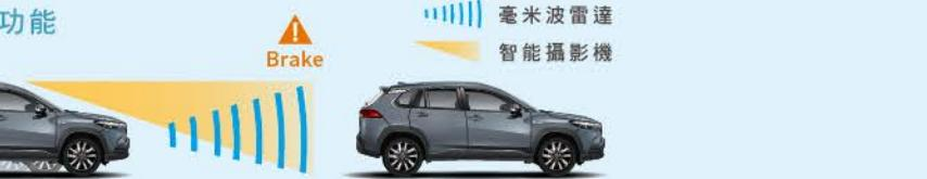
當判定極有可能與前方車輛、行人及自行車手發生碰撞風險，必要時系統將自動啟動煞車，避免事故發生或降低意外造成的傷害。
