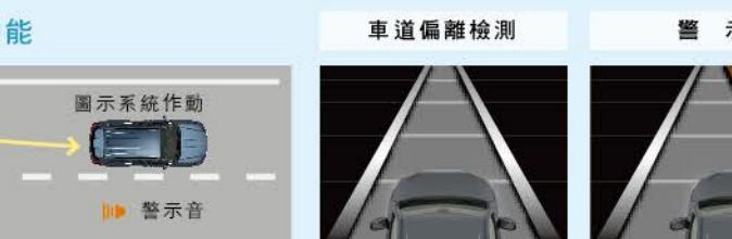
後視鏡前方智能攝影機可偵測路面分隔線，於時速50公里以上而未打方向燈、且系統判斷偏離車道時，多功能資訊顯示幕會顯示警示訊息，並響起警示音以提醒駕駛。
