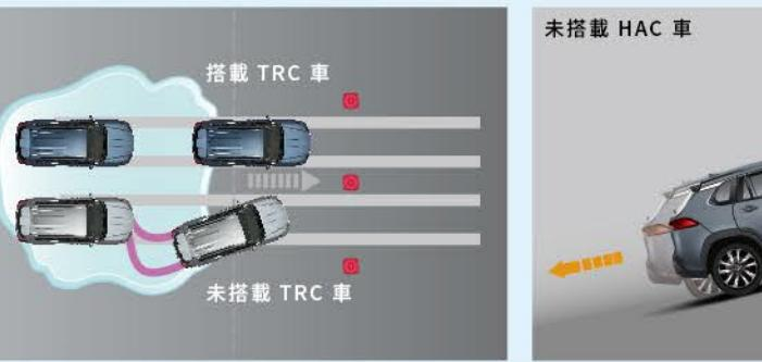
透過系統控制，有效抑制車輛於濕滑路面起步或加速時，可能發生的輪胎打滑。
