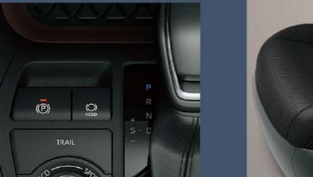
■ EPB電子駐車煞車系統
