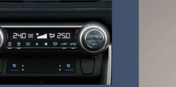
■ S-Flow智慧型雙區恆溫控制空調系統
