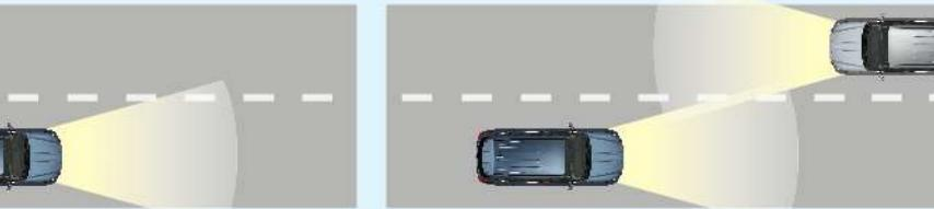
偵測對向車輛頭燈及前方車輛尾燈光源，自動切換遠光燈，避免來車受到頭燈直射。
