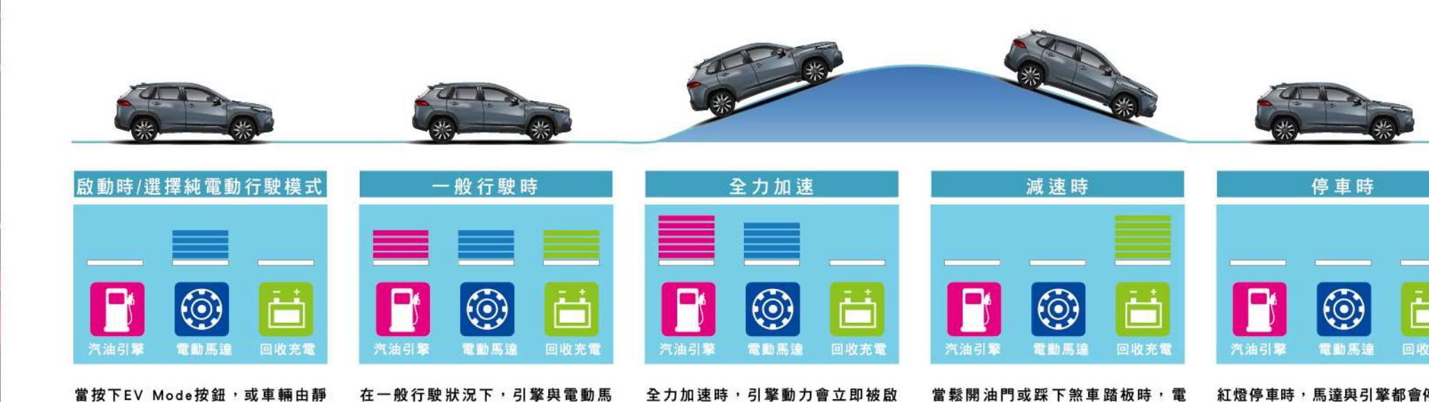
當按下EV Mode按鈕，或車輛由靜止啟動時，車輛可以僅靠電動馬達有效率地被交互通用，以達到最省油的動力輸出狀態。當引擎輸出動力超過實際駕駛需求時，多餘動力將為HYBRID電池充電，提供最有效的動能運用。
