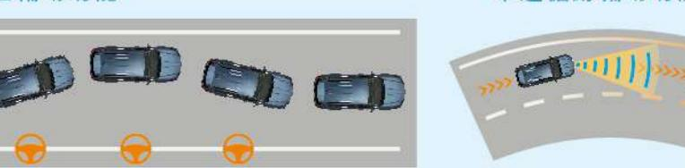
當系統判斷車輛可能偏離車道時，系統會於方向盤施予反向回饋力道，修正行車路線，協助車輛維持行駛在車道內。
