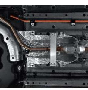
於底盤中央通道採用鋁合金剛性強化支架，有效強化車身剛性，提供車主更多操駕樂趣。
