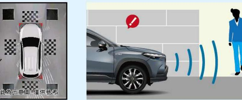
當車速低於時速25公里或倒車時，系統會自動發出聲響提醒行人，以避免巷弄間油電車以電力行駛時，發生行人未察覺、遭受碰撞的意外。
