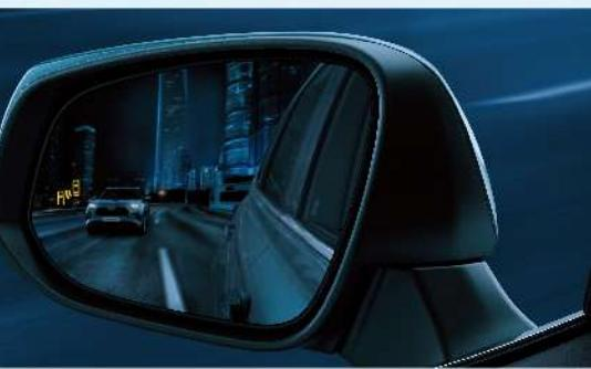
行駛於市區或高速道路上，系統能隨時自動偵測後方盲點區域的來車，以警示燈提醒駕駛，大幅提升變換車道時的行車安全。
