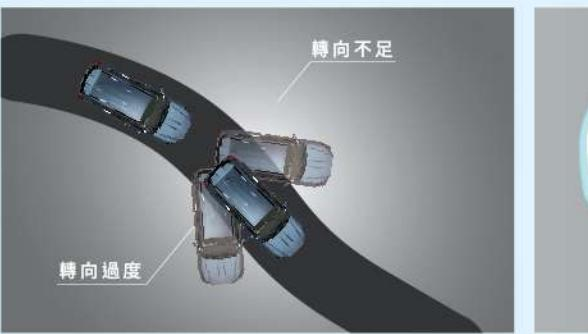
當車輛偏離路面、轉向過度或不足時，VSC 將調整動力輸出，再透過EPS電子式動力輔助方向盤修正方向盤角度，主動掌握行車安全。
