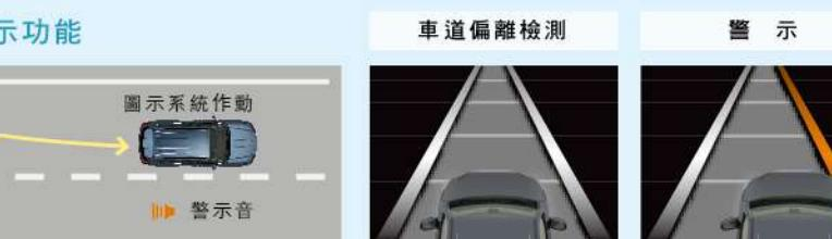
後視鏡前方智能攝影機可偵測路面分隔線，於時速50公里以上而未打方向燈、且系統判斷偏離車道時，多功能資訊顯示幕會顯示警示訊息，並響起警示音以提醒駕駛。
