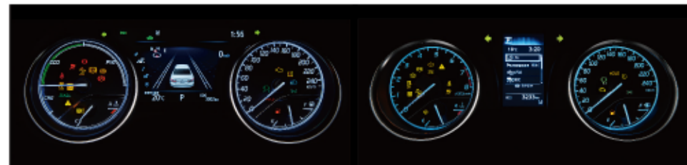
7吋TFT MID儀錶板 (HYBRID車型)
