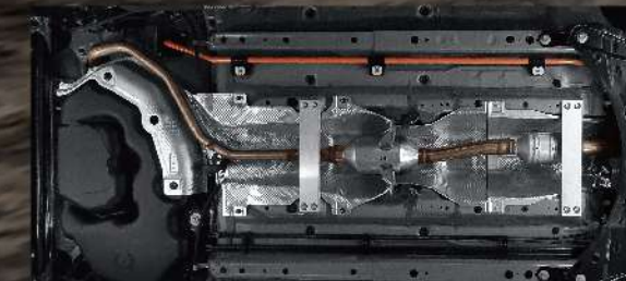
底盤雙鋁合金剛性強化支架
