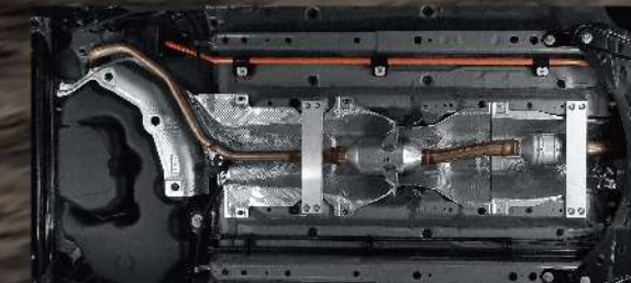
底盤雙鋁合金剛性強化支架
