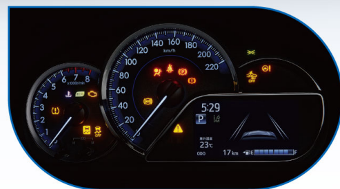
湛藍自發光儀錶板附 4.2吋全彩TFT MID多功能資訊顯示幕(豪華)
