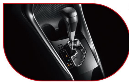
Super CVT-i無段變速系統 附7速序列式手自排 寬廣的變速齒比範圍，可連續無停滯地變速行進，減少換檔所消耗的引擎動力與燃油損失，感受平順無頓挫的舒適駕駛感受；搭配7速序列式手自排，享受靈敏流暢的全新操控樂趣。
