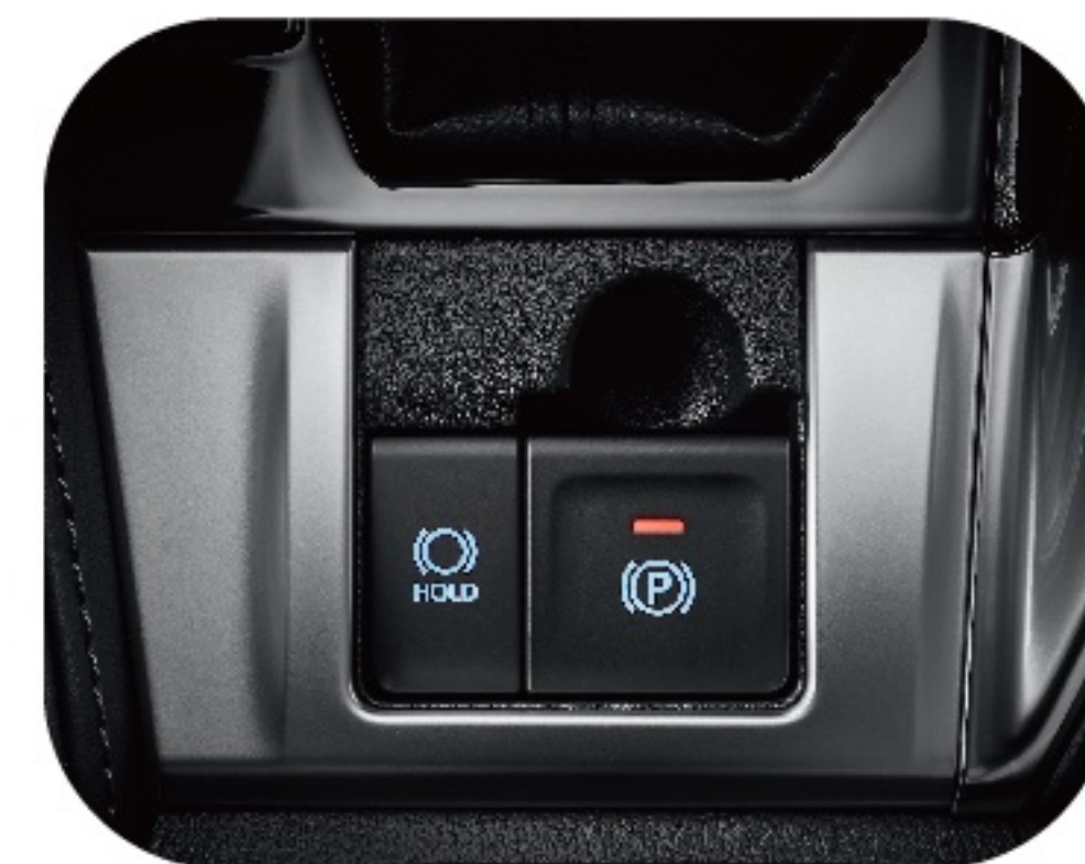
EPB電子駐車煞車系統(附Auto Hold功能) (圖示為潮玩版车型)
