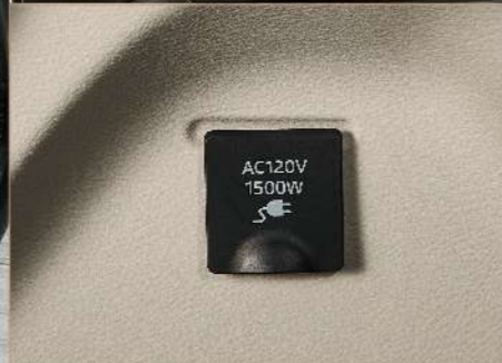
1,500瓦電源供應器附雙AC120V插座 (中央扶手後方/後行李廂)
