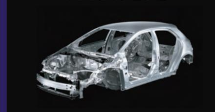
基於TNGA新世代造車工藝，底盤、車身結構大量採用高剛性鋼材，與最新雷射強化焊接技術，藉由降低焊點距離，大幅增加焊點數量，使得車身抗扭剛性更為提升，強化行車穩定性。
