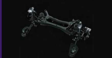
新世代獨立後雙A臂懸吊，搭配最適化的彈簧與減震筒設定，帶來更好的乘坐舒適性、操控性、高速行駛穩定性以及指向性等多項駕駛性能。
