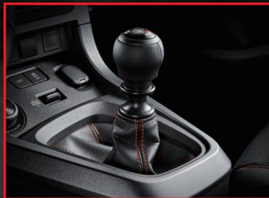
變速箱搭載iMT智能換檔科技，能於升降檔時自動偵測引擎轉速，適時補油維持轉速以避免換檔後產生頓挫，提供更為順暢的換檔體驗與靈敏的加速表現。
