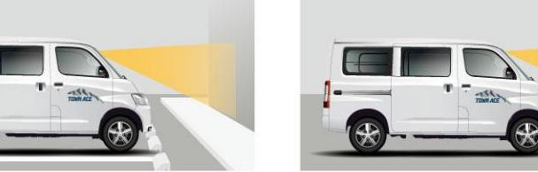
當系統判斷車主誤踩油門且有碰撞障礙物風險時，將提醒車主並主動煞車。
