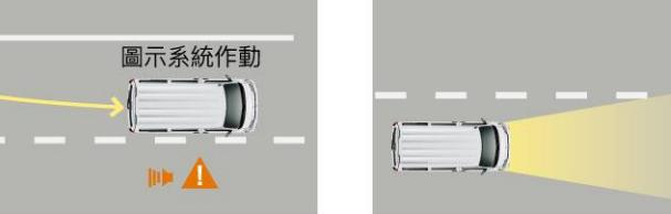
前方智能攝影機可偵測路面分隔線，於時速60公里以上而未打方向燈、且系統判斷偏離車道時，儀錶將顯示警示訊息，並響起警示音以提醒駕駛。
