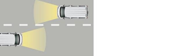
偵測對向車輛頭燈及前方車輛尾燈光源，自動關閉、開啟遠光燈，避免來車受到頭燈直射。
