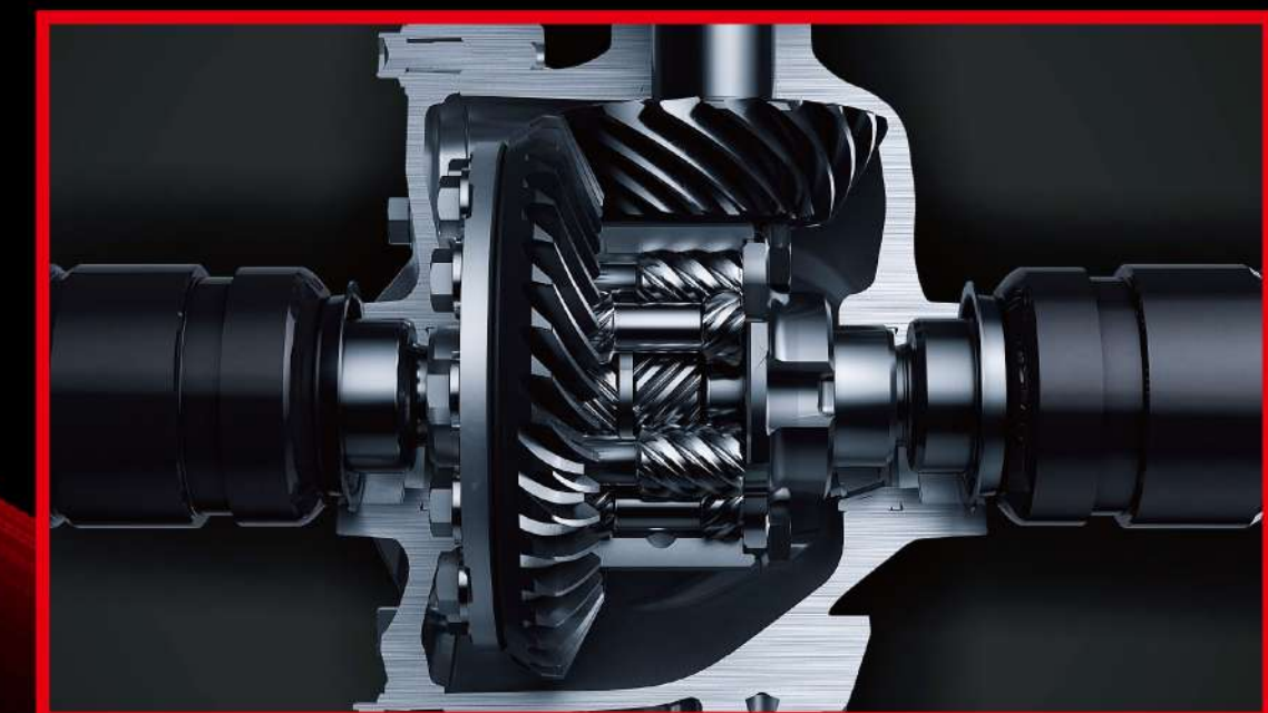
Torsen® LSD 前、後軸限滑差速器
