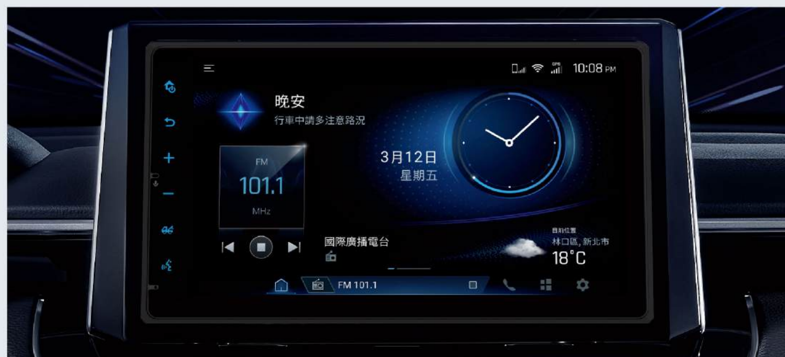
TOYOTA Drive+ Link 智能車載系統(9吋 Wi-Fi 觸控式) 支援無線 Apple CarPlay 與 Android Auto
