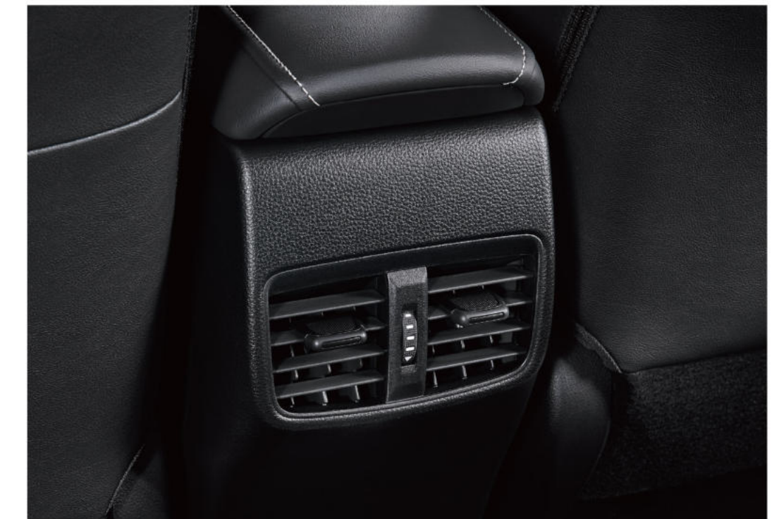
|| 後座空調出風口
