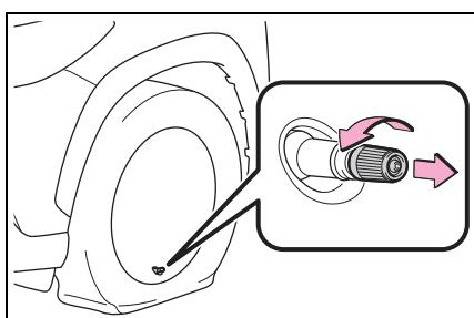
**6 延長軟管。拆下軟管上的放氣蓋。**
