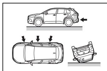
**SRS 輔助氣囊可能不會觸發的撞擊類型 (雙前座椅側 SRS 輔助氣囊及雙前座 (雙後座) 車側簾式 SRS 輔助氣囊 [若有此配備])**
