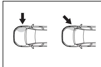
雙前座椅側 SRS 輔助氣囊的設計並不是在車輛遭受正面撞擊、後方撞擊、翻覆或低速的側面撞擊時觸發。
