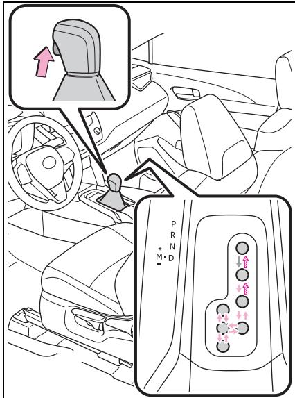
←：引擎開關在點火開關開啟模式時踩下煞車踏板 \*，按下排檔頭排檔釋放按鈕的同時移動排檔桿。
