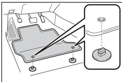
**2 旋轉每個固定鉤(扣)的上方旋鈕來固定腳踏墊的位置。**
