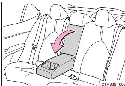
後置杯架插入隔板可以拆下清潔。
