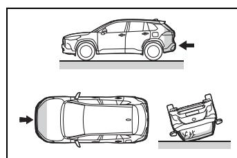
雙前座 (雙後座) 車側簾式 SRS 輔助氣囊的設計並不是在車輛遭受後方撞擊、翻覆或低速的側面或正面撞擊時觸發充氣。
