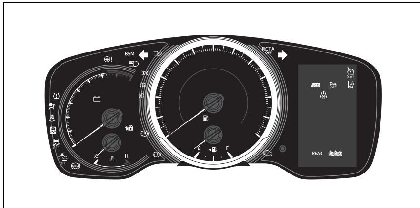
► 多功能資訊顯示幕 (7 吋顯示幕 [類比式速率表顯示時])
