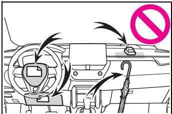
● 未配備雙前座 (雙後座) 車側簾式 SRS 輔助氣囊車型：不可將任何東西安裝在車門、擋風玻璃和車窗等部位。
