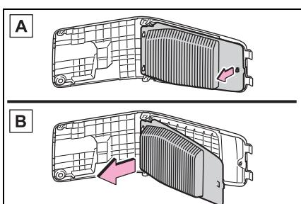
**A** 如圖示拆開固定爪。
