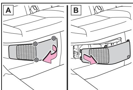
**A** 如圖示拉護蓋使 3 個固定爪分離，從右上方角落的固定爪開始。
