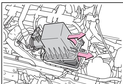
**3 完成檢查後，必須確定空氣濾芯有正確的安裝妥當。固定爪完全**
