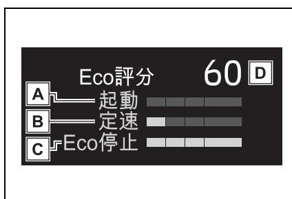
**A 節能起步狀態****B 節能定速狀態****C 節能停止狀態****D 得分****如何判讀條型圖**
