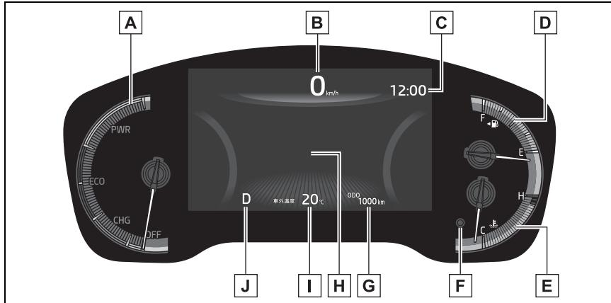
**A** 油電複合動力系統指示器
