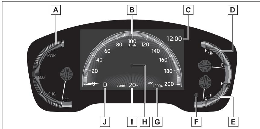
**A** 油電複合動力系統指示器
