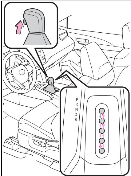
← POWER 開關在 ON 模式，並已踩下煞車踏板<sup>\*</sup>時，按下排檔頭排檔釋放按鈕的同時移動排檔桿。
