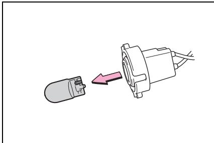
**8 安裝新的燈泡，然後插入燈泡座並順時鐘方向轉動燈泡座來安裝。**
