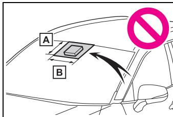
**A** 從擋風玻璃頂部到攝影機感知器底部下方約 1 cm 處
