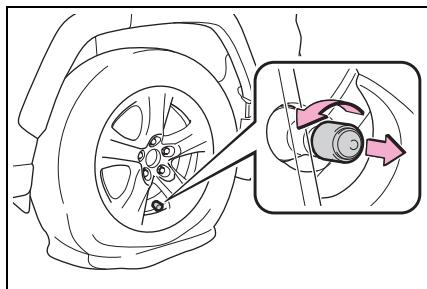
**6 拉出軟管。拉出軟管。拆下軟管上的空氣釋放蓋。**
