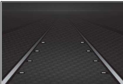
表示系統正在辨識白線(黃線)或航道<sup>\*</sup>。當車輛偏離車道時，該側顯示的白線即會閃爍橘色。
