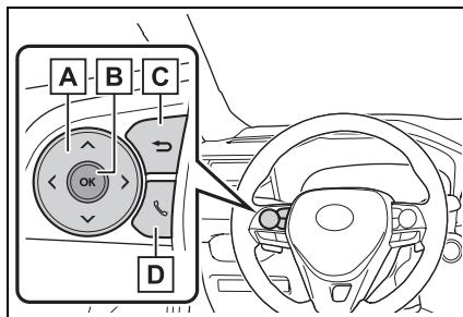
**A** 滾動畫面<sup>\*</sup> / 切換顯示<sup>\*</sup> / 移動選擇項目
