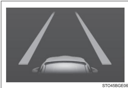
表示系統正在辨識白線 (黃線)。當車輛偏離車道時，該側顯示的白線即會閃爍橘色。
