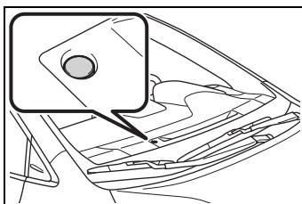
如果有異物附著在感知器上或感知器被擋風玻璃上附著的東西遮蓋時，感知器可能無法正常作用。這樣會使感知器在偵測車外燈光的亮度時受到干擾，並可能造成自動頭燈系統功能不正常。
