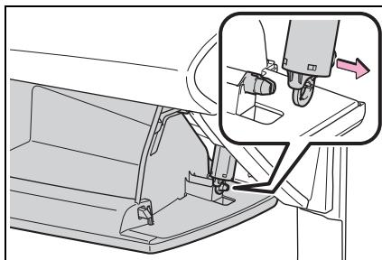
3 將手套箱靠車輛外側處往內推，使固定爪退出。接著將手套箱向外拉，並將下固定爪退出。
