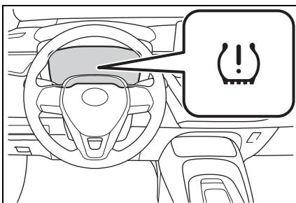
**9** 若安裝輪組的規定胎壓與前一組相異，便需執行 TPMS 胎壓偵測警示系統的胎壓設定程序。( $\rightarrow$ P.239)
