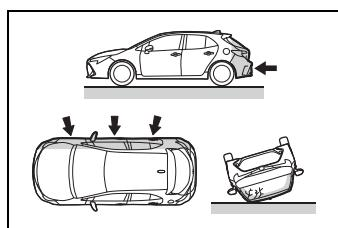
如果車輛遭受側面特定角度撞擊、或是撞擊車廂以外的其他車側部位時，雙前座椅側 SRS 氣囊及車側簾式 SRS 氣囊就有可能不會作動。
