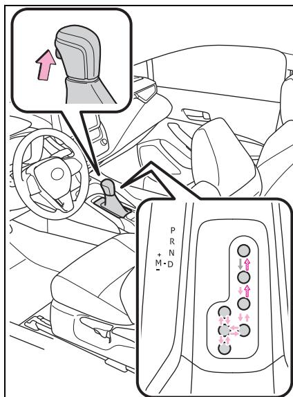
←：當引擎開關在 ON 並且煞車踏板踩下時 \*，按住排檔頭排檔釋放按鈕的同時移動排檔桿。
