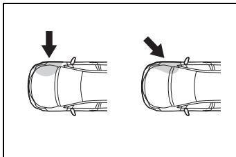
雙前座椅側 SRS 氣囊的設計並不是在車輛遭受正面撞擊、後方撞擊、翻覆或低速的側面撞擊時觸發。
