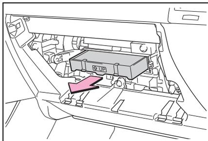
**7** 從空調濾芯外框上拆下空調濾芯，並更換新品。
