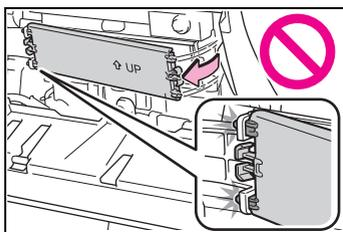
清潔油電複合動力電池 ( 驅動電池 ) 通風口
