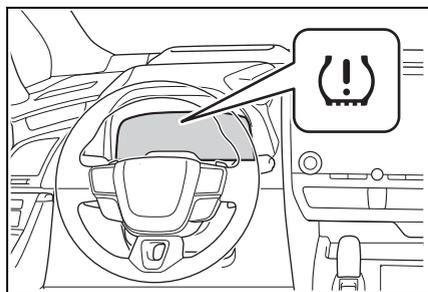
**7** 如果已安裝輪胎組的規定輪胎胎壓不同於先前輪胎組的胎壓，將會需要執行 TPMS 胎壓偵測警示系統的胎壓設定程序。(→P.374)
