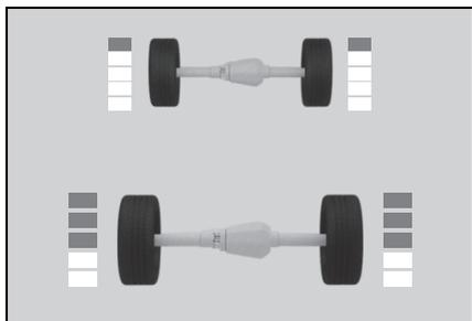
扭力分配顯示：顯示各車輪的驅動
