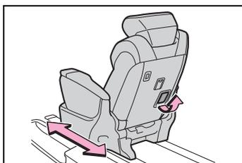
拉起第二排座椅後方的拉桿。
