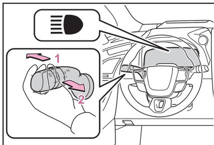
1 頭燈亮起時，將控制桿往離您的方向推即可開啟遠光燈。
