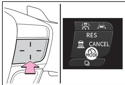
**2** 使用油門踏板加速至所需的車速（約 30 km/h 或以上），然後按下駕駛輔助開關即可設為設定的車速。
