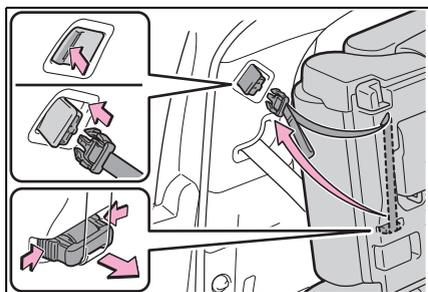
**11** 用手抓住座椅的同時拉出固定帶以便固定座椅。
