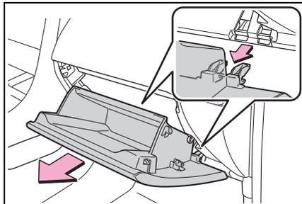
**5** 解開濾芯蓋 (A)，將濾芯蓋從固定爪拉出 (B)，然後拆下濾芯蓋。
