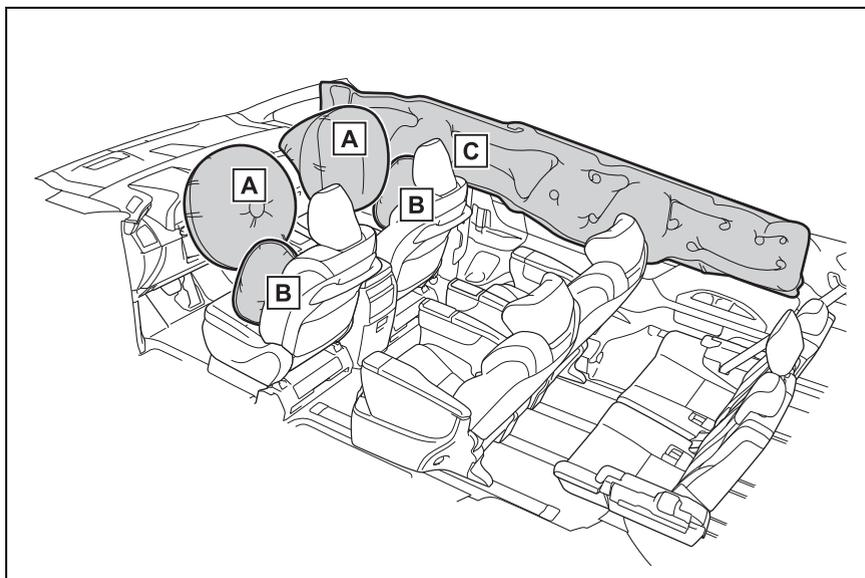
**A** SRS 前方氣囊 (SRS 駕駛座氣囊 / SRS 前乘客座氣囊)
