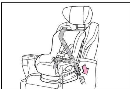
**5** 如果您的兒童安全座椅未配備鎖定功能 ( 安全帶鎖定功能 )，則使用固定夾來固定兒童安全座椅。
