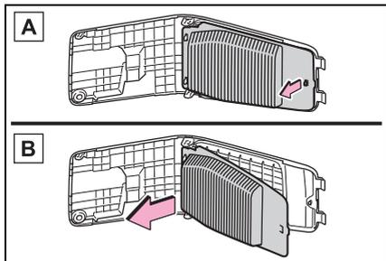
**A** 如圖示拆開固定爪。
