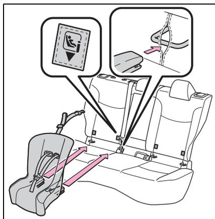
3 安裝兒童安全座椅後, 前後搖動兒童安全座椅確認已安裝牢固。(→P.43)
