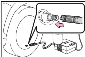
**3** 從氣嘴上拆開軟管，將放氣蓋從軟管上拆下，然後重新接上軟管。
