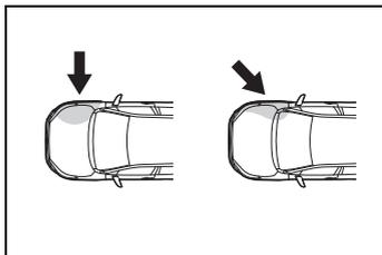
雙前座 (雙後座) 車側簾式 SRS 輔助氣囊的設計並不是在車輛遭受正面撞擊、後方撞擊、翻覆或低速的側面撞擊時觸發。
