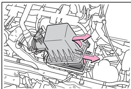
3 完成檢查後，必須確定空氣濾芯有正確的安裝妥當。固定爪完全嵌合後，使用固定扣確實將空氣濾清器外蓋裝好。
