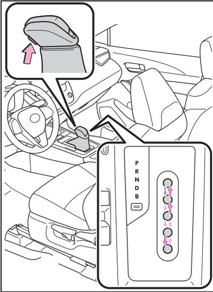
← POWER 開關在 ON 模式，並已踩下煞車踏板\* 時，按下排檔頭排檔釋放按鈕的同時移動排檔桿。
