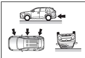
■ SRS 氣囊可能不會觸發(充氣)的撞擊類型(SRS 側氣囊及車側簾式氣囊)
