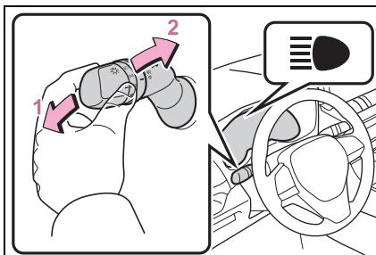
1 頭燈亮起時，將控制桿往離您的方向推即可開啓遠光燈。
