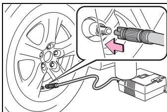
**3** 從氣嘴上拆開軟管，將空氣釋放蓋從軟管上拆下，然後重新接上軟管。
