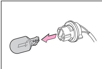
5 安裝新的燈泡，然後插入燈泡座並順時鐘方向轉動燈泡座來安裝。
