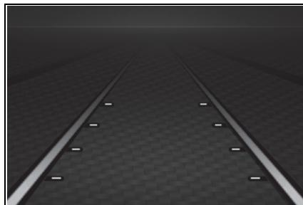
表示系統正在辨識白線 (黃線)或航道<sup>\*2</sup>。當車輛偏離車道時，該側顯示的白線即會閃爍橘色。
