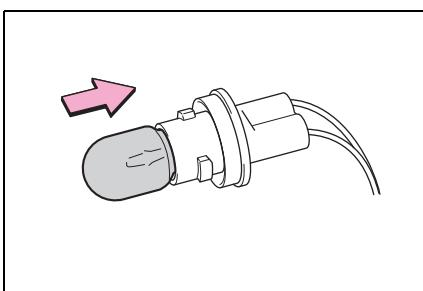
**5 將燈泡底座安裝到燈具上，先插入再順時針轉動燈泡底座。**
