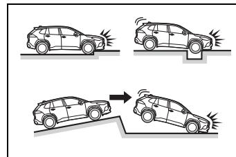
■ SRS 輔助氣囊可能不會觸發的撞擊類型 (前座 SRS 輔助氣囊)
