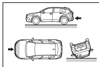
車側簾式 SRS 輔助氣囊的設計並不是在車輛遭受後方撞擊、翻覆或低速的側面或正面撞擊時觸發充氣。
