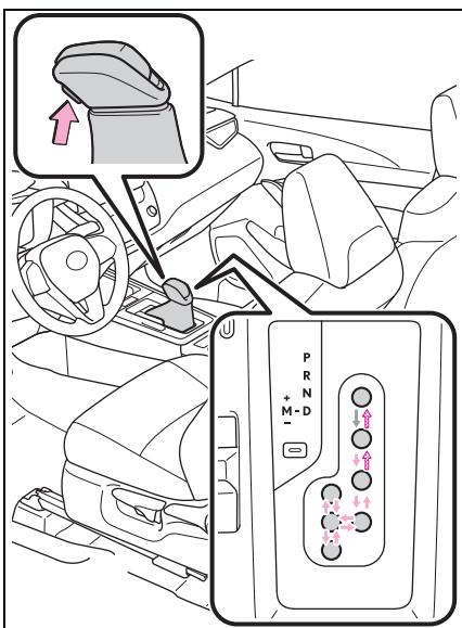
←：引擎開關在 ON(點火開關開啟)模式時踩下煞車踏板<sup>\*</sup>，按下排檔頭排檔釋放按鈕的同時移動排檔桿。
