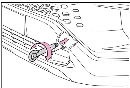
**4** 使用輪圈螺帽扳手或堅硬的金屬棒將拖吊鉤環鎖緊。
