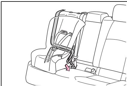
**3 如果您的兒童安全座椅沒有配備鎖定功能(安全帶鎖定功能)，則使用固定夾來固定兒童安全座椅。**
