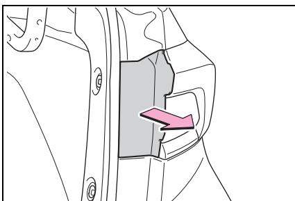
4 拆下 2 顆螺絲，然後將燈組件向後筆直拉出，將其拆下。
