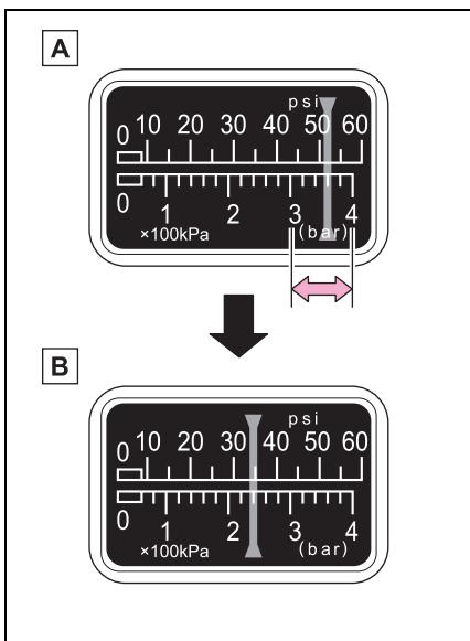
**A** 密封劑會被噴入輪胎，而壓力會介於  $300\text{ kPa}$  ( $3.0\text{ kgf/cm}^2$  或  $\text{bar}$ ,  $44\text{ psi}$ ) 與  $400\text{ kPa}$  ( $4.0\text{ kgf/cm}^2$  或  $\text{bar}$ ,  $58\text{ psi}$ ) 之間，然後緩慢降低。
