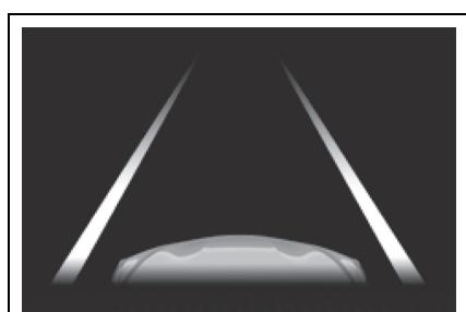
表示系統正在辨識白線(黃線)或航道<sup>\*</sup>。當車輛偏離車道時，該側顯示的白線即會閃爍橘色。
