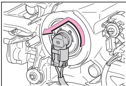
2 壓下接頭鎖定釋放時拉出燈泡。
