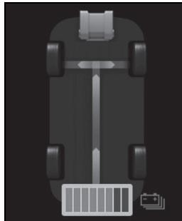
當車輛動力由汽油引擎及電動馬達(驅動馬達)提供時
