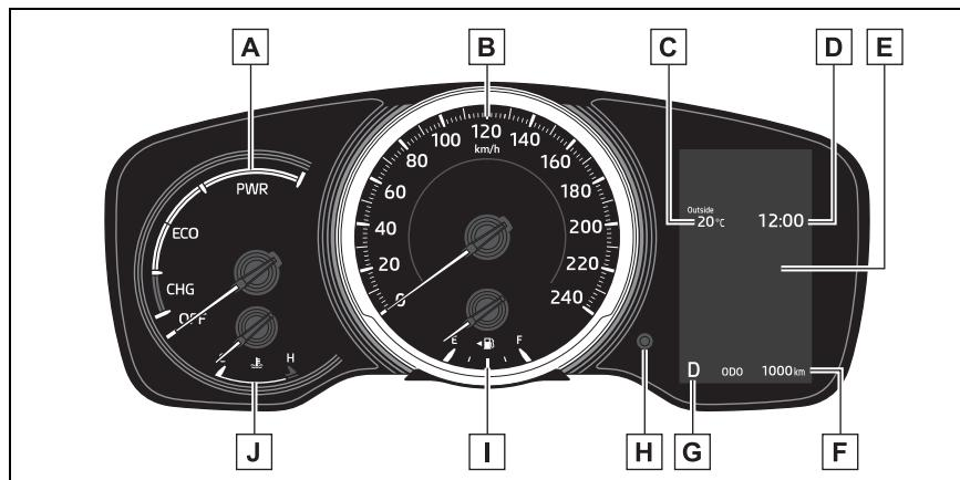
**A** 油電複合動力系統指示器
