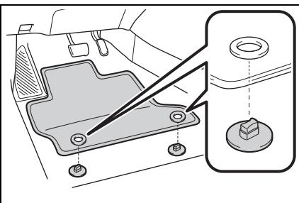
**2 轉動每一個固定鉤(固定扣)的上部旋鈕以確保踏腳墊有裝入定位。**
