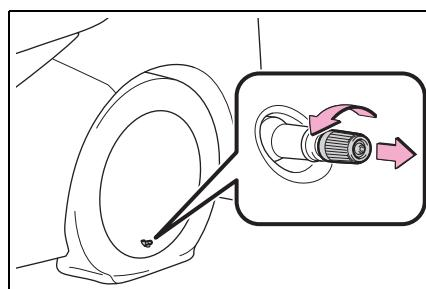
**6 拉出軟管。拆下軟管上的空氣釋放蓋。**
