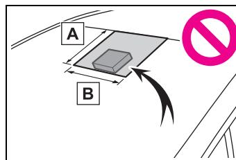
**A** 從擋風玻璃頂部到前攝影機底部下方約 1 cm 處
