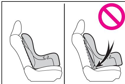
\*<sup>2</sup>:如果頭枕會妨礙兒童安全座椅的安裝，且頭枕為可拆式，請拆下頭枕。否則，請將頭枕調整到最高位置。
