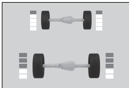
扭力分配顯示：顯示各車輪的驅動狀態，分成 6 段，範圍介於 0 至 5。
