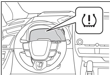
7 如果已安裝輪胎組的規定輪胎胎壓不同於先前輪胎組的胎壓，將會需要執行 TPMS 胎壓偵測警示系統的胎壓設定程序。( $\rightarrow$ P.374)
