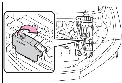
4 連接正極跨接電纜線夾至您車輛的 **A**，並將另一端的正極跨接電纜線夾連接至另一輛車的**B**。然後將負極跨接電纜線夾連接至另一輛車的**C**，並將另一端的負極跨接電纜線夾連接至**D**。
