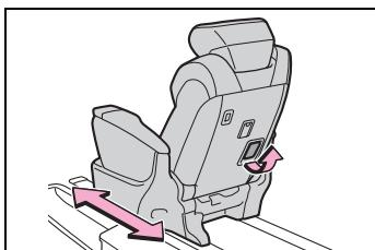
拉起第二排座椅後方的拉桿。
