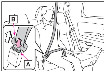
2 若要解開扣入的接片「A」，請將機械式鑰匙 (→P.92) 或接片「B」插入帶扣上的孔洞中。
