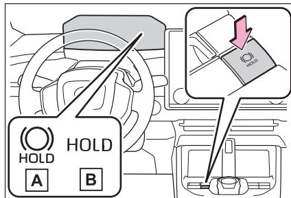
■ Auto Hold 自動定車煞車系統作用條件
