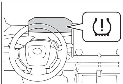
7 若安裝輪組的規定胎壓與前一組相異，便需執行 TPMS 胎壓偵測警示系統的胎壓設定程序。(→P.353)
