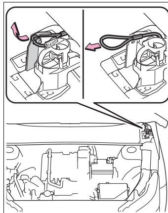
3 AC 充電接頭解鎖後，將緊急釋放鋼索的把手固定至固定座。
