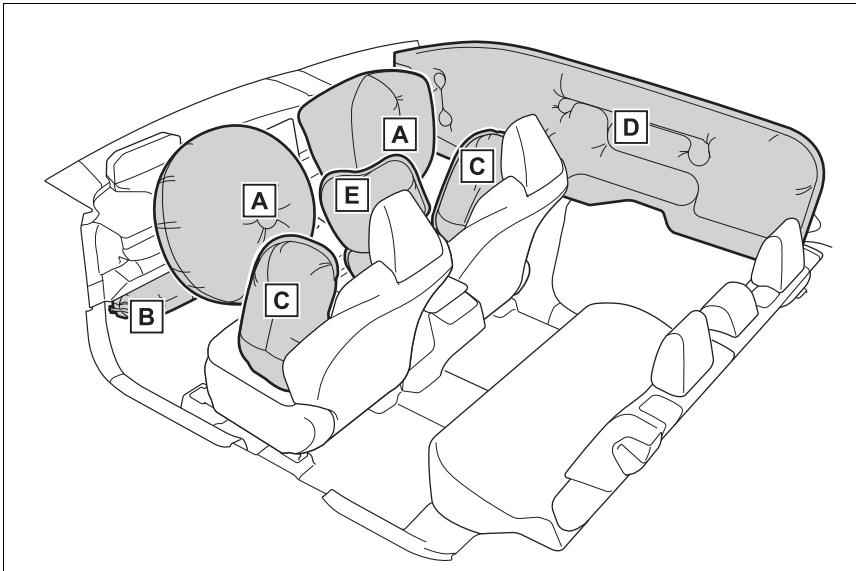
**A** SRS 前氣囊 (SRS 駕駛座氣囊 / SRS 前乘客座氣囊 )
