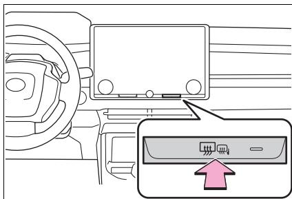
後擋風玻璃除霧器和車外後視鏡除霧器會作動，為後擋風玻璃和車外後視鏡除霧。
